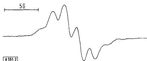
Abb. 3. ESR-Spektrum des 2,6-Bis(pentadeuteriophenyl)-4-phenylphenoxyis in Benzol bei 60 °C.
